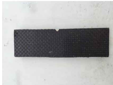
รูปที่ 4 ชิ้นงานคอมโพสิตสำหรับการทดสอบตามมาตรฐาน ASTM (E23)
